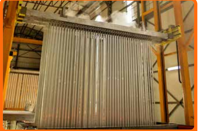
Dikey Yüzey İşlem Hattı
