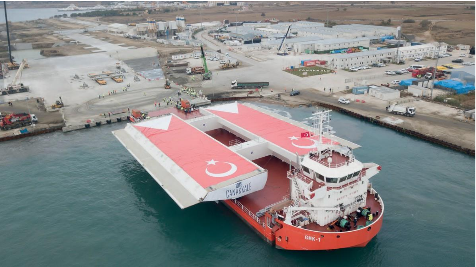
1915 Çanakkale Köprüsü Tabliyelerinin Taşınması Projesi
