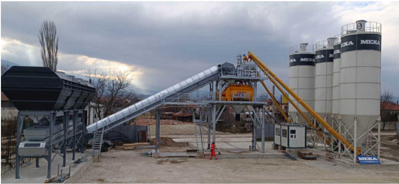
▲ Meka Kompakt Beton Santrali Kurulumu-2024 Bulgaristan
